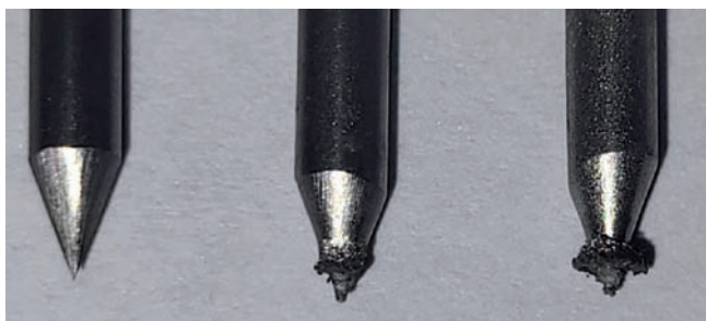
Obr. 1 Tri štádiá kontaminácie (zľava): čistá, mierne kontaminovaná, silne kontaminovaná volfrámová elektróda
