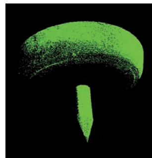
Obr. 3 Naskenované mračno bodov zachytávajúce volfrámovú elektródu s keramickej dýzou zváracieho nástroja
