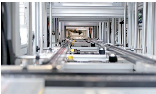
Čítacie/zapisovacie zariadenia RFID inštalované na linke zaznamenávajú všetky prepravné nosiče dielov a umožňujú tak bezproblémovú dokumentáciu procesov.
