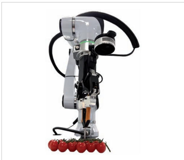
Ruka robota dokáže manipulovať s jemnými produktmi bez ich stláčania.
