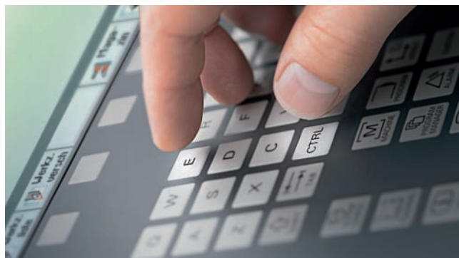
Kombinácia kláves Ctrl + E poskytuje prehľad o spotrebe energie CNC stroja (© Siemens AG).
