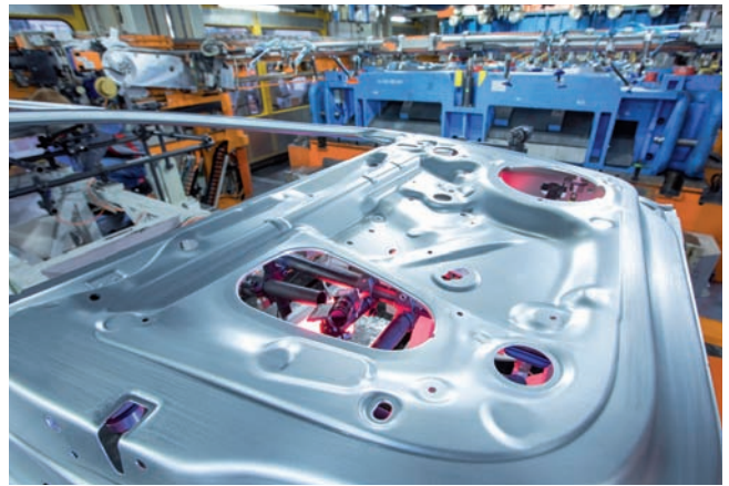
Ako jeden z prvých výrobcov automobilov na svete využíva Audi strojové učenie v sériovej výrobe. Softvér, ktorý Audi vyvinulo, rozpozná a označí najmenšie praskliny na plechových dieloch – automaticky, spoľahlivo a v priebehu niekoľkých sekúnd. Audi týmto projektom podporuje umelú inteligenciu v spoločnosti a revolúciu v testovaní procesov vo výrobe.
