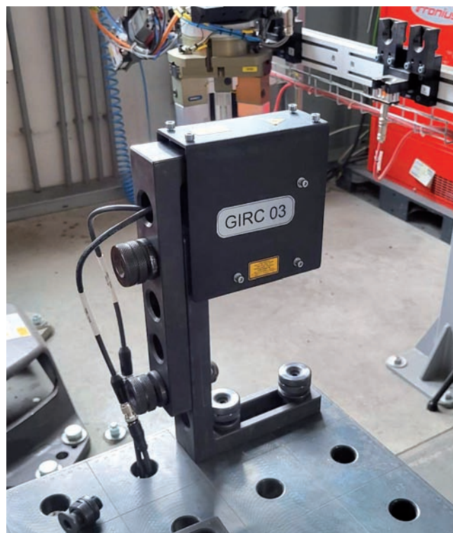
Obr. 2 Rozšírenie inteligentného robotického pracoviska o laserový 2D skener
