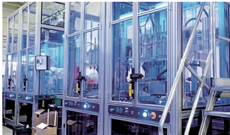
Liniové LED diódy WLS27 farebne zobrazujú príslušný stav modulu
