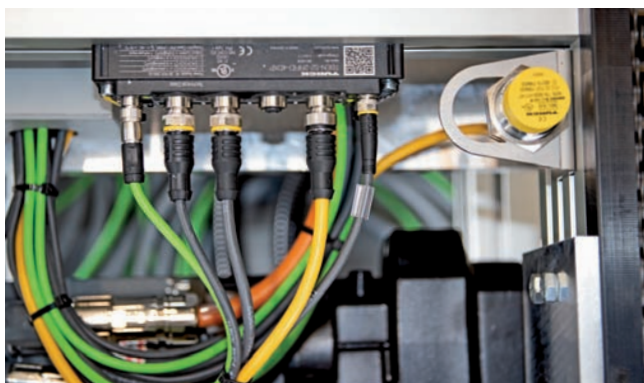
Rozhrania TBEN RFID možno vďaka ich kompaktnému dizajnu jednoducho namontovať takmer kdekoľvek.
