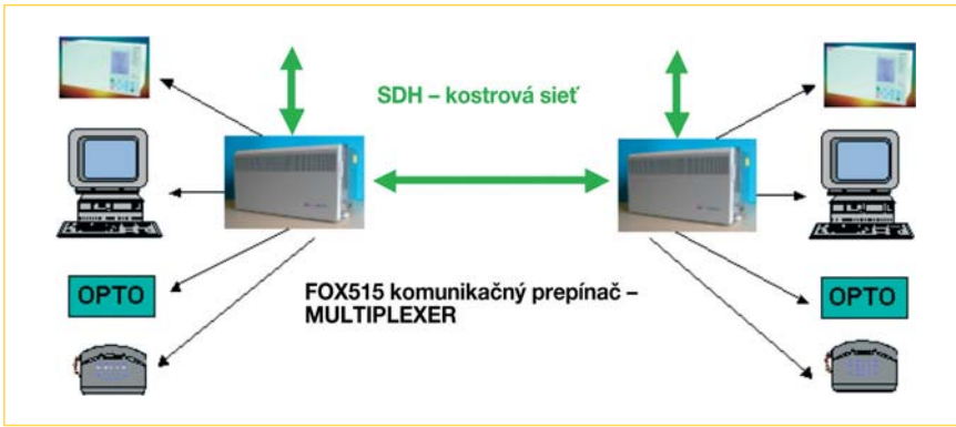
Obr.1 Začlenenie FOX515 do komunikačnej štruktúry
