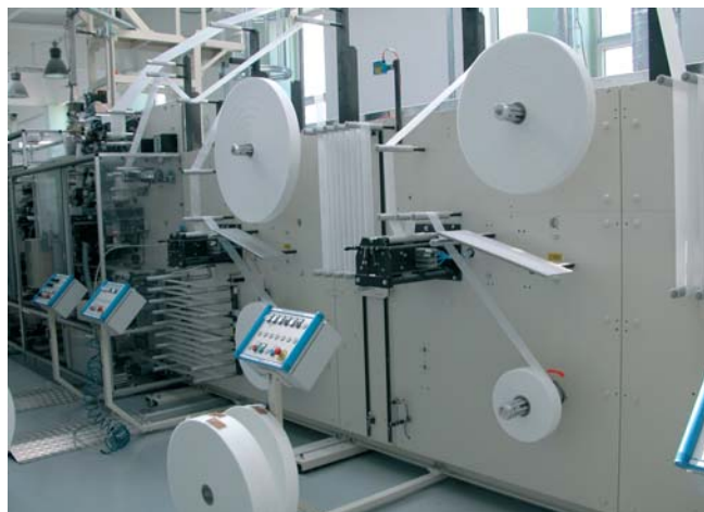
Off-line panel odvíjačov – distribučná vrstva a vrchná vrstva. V pozadí začiatok výrobnéj linky s miestom spájania materiálov
